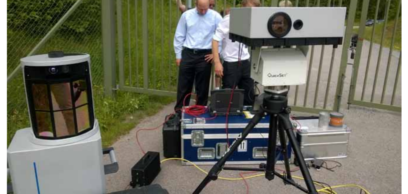
Kuvassa vasemmalla Bruker SIGIS 2 skannaava kaasunkuvannuslaite ja oikealla Bruker HI90 hyperspektrikamera. (Kuva: Timo-Jaakko Toivanen)
