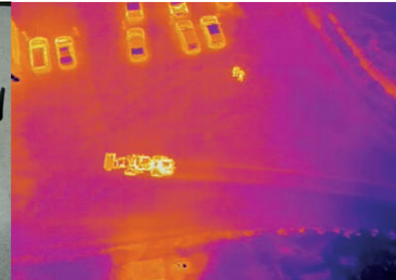
Kuva 3. Lämpökuvaa parkkipaikalla liikkuvasta kauhakuormaajasta, jonka kulkureitti näkyy renkaiden jättäminä taustaa lämpöisempinä uurteina. (Kuva: Petri Wallgrén)
