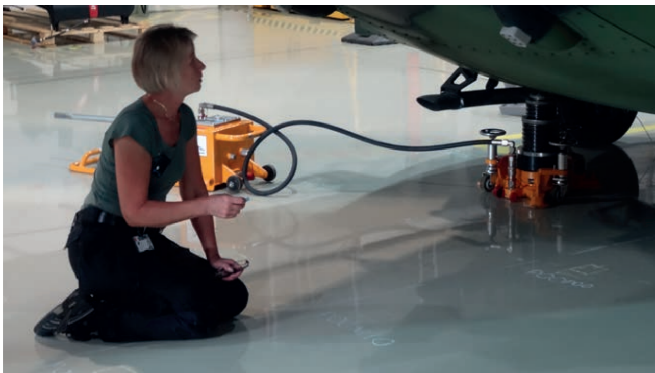
Kuvat 4 ja 5. NH90-helikopterin kalibrointi käynnissä. Kalibroijien takana helikopterin takarampin päällä ovat kiinnitys rakenteet, joissa ilmaisimet sijaitsevat. Toisessa kuvassa Eija Isolehto on varmistamassa hilan merkintöjä, kun helikopteri on nostettu tunkeilla tavanomaiseen lentoasentoon niin, että ilmaisinten alapinta on yhden metrin korkeudella lattiatasosta. Lattiatasolle on piirretty hilapisteet, joihin kalibrointilähteet sijoitetaan. Kalibrointi suoritettiin HPGe-, NaI-, LaBr 3 - ja CdZnTe-ilmaisimille. Näiden ilmaisinten säteilyä havaitsevan aktiivisen alueen koko on 4000 cm 2 —1 cm 3 . Suuremmat ilmaisimet antavat tehokkuutta pistemäisen lähteen etsimiseen, ja korkeamman resoluution ilmaisimet mahdollistavat ihmiselle vaarallisempien isotooppien tarkan analyysin hyvän erottelukyvyn vuoksi. Suurin osa analyysistä tehdään automaattisesti sitä varten kehitetyillä reaaliaikaisen mittauksen analyysiohjelmistoilla. (Kuvat: Eija Isolehto ja Markku Kettunen)
