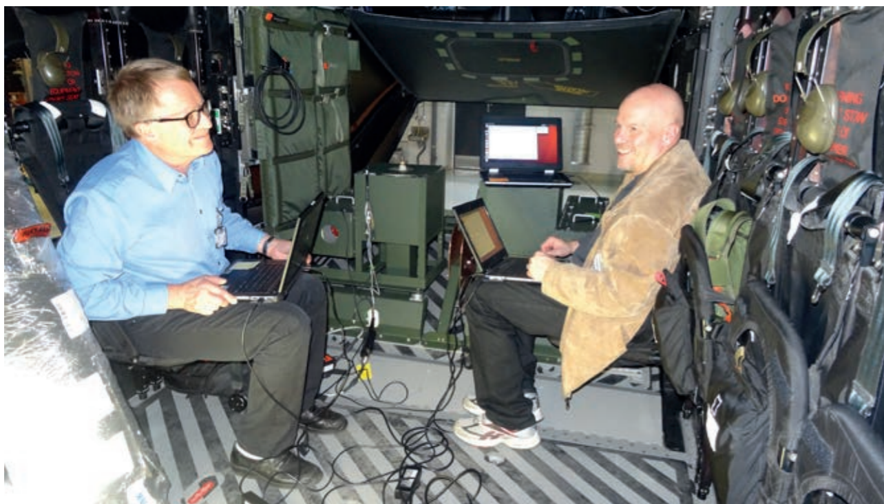
Kuvat 4 ja 5. NH90-helikopterin kalibrointi käynnissä. Kalibroijien takana helikopterin takarampin päällä ovat kiinnitys rakenteet, joissa ilmaisimet sijaitsevat. Toisessa kuvassa Eija Isolehto on varmistamassa hilan merkintöjä, kun helikopteri on nostettu tunkeilla tavanomaiseen lentoasentoon niin, että ilmaisinten alapinta on yhden metrin korkeudella lattiatasosta. Lattiatasolle on piirretty hilapisteet, joihin kalibrointilähteet sijoitetaan. Kalibrointi suoritettiin HPGe-, NaI-, LaBr 3 - ja CdZnTe-ilmaisimille. Näiden ilmaisinten säteilyä havaitsevan aktiivisen alueen koko on 4000 cm 2 —1 cm 3 . Suuremmat ilmaisimet antavat tehokkuutta pistemäisen lähteen etsimiseen, ja korkeamman resoluution ilmaisimet mahdollistavat ihmiselle vaarallisempien isotooppien tarkan analyysin hyvän erottelukyvyn vuoksi. Suurin osa analyysistä tehdään automaattisesti sitä varten kehitetyillä reaaliaikaisen mittauksen analyysiohjelmistoilla. (Kuvat: Eija Isolehto ja Markku Kettunen)
