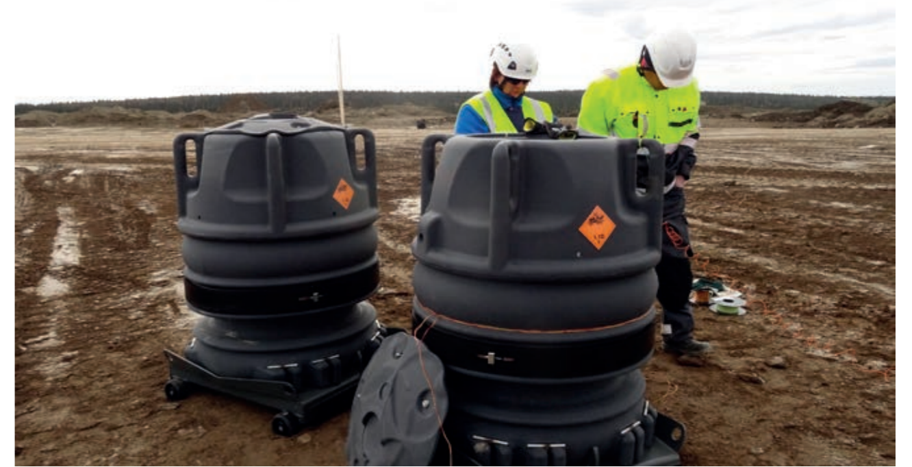
PM16-merimiinan välittymistestin valmistelua — räjäytettävää miinaa nallitetaan koetta varten PVTUTKL:n räjähteiden käytöstä vastaavan johtajan valvonnassa. (Kuva: Marja-Leena Karisaari)
