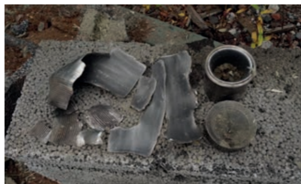
Näyteputki tykkiruutinäytteelle tehdyn SCO-testin jälkeen. (Kuva: Marja-Leena Karisaari)
