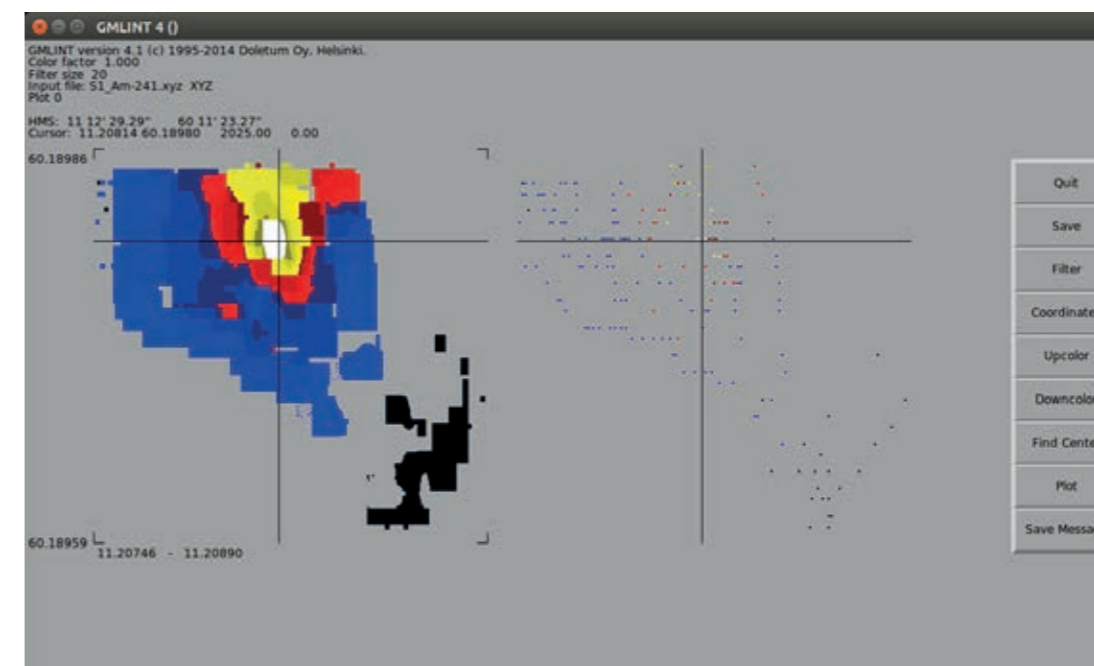
Kuva 6. Alue S1. GMLINT-ohjelmalla on mallinnettu säteilypinta (Am-241). Mittauspisteet ovat kuvassa oikealla. Kursori osoittaa aktiivisinta kohtaa, ja aktiivisuusarvo (2025) ja sen koordinaatit ovat luettavissa kuvasta.
