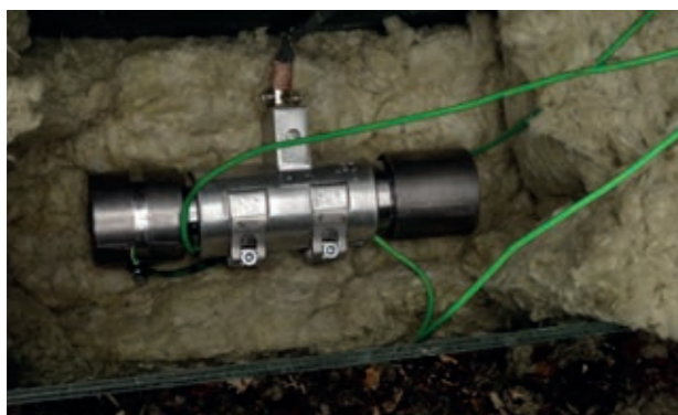
Räjähdyssainenäyte ladattuna teräksiseen näyteputkeen SCO-testiin. (Kuva: Marja-Leena Karisaari)
