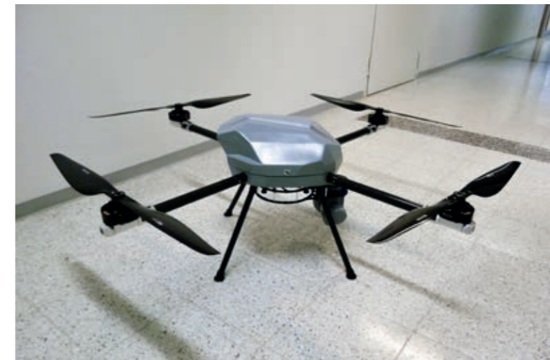
Kuva 4. 10 kg:n painoinen Threod KX4-LE -multikopteri lentoonlähetykunnossa. (Kuva: Petri Wallgrén)
