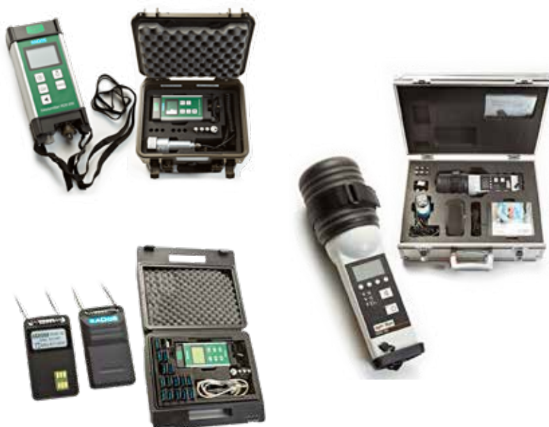
KUVA 28. Säteilymittareita (Annosnopeusmittari RDS-200, annosmittari RDD-20 ja säteilyanalysaattori HDS-100)
