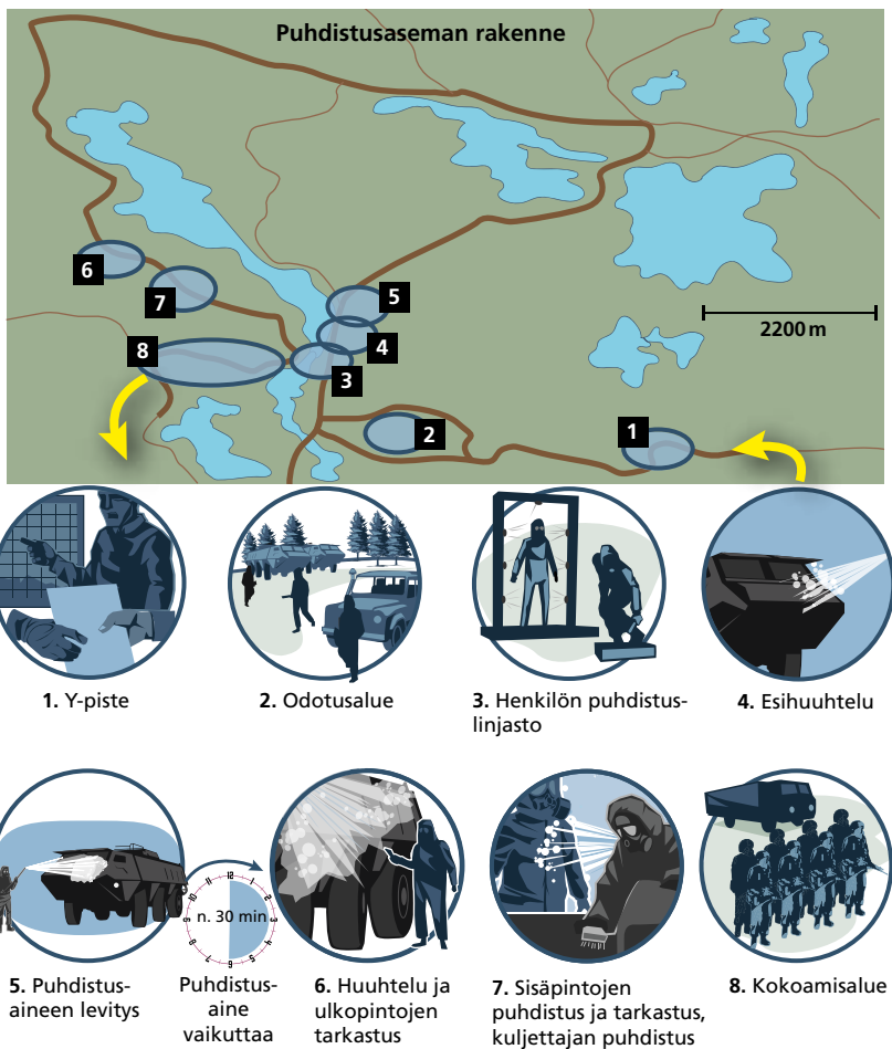
KUVA 74. Esimerkki komppanian rakentaman puhdistusaseman rakenteesta.
