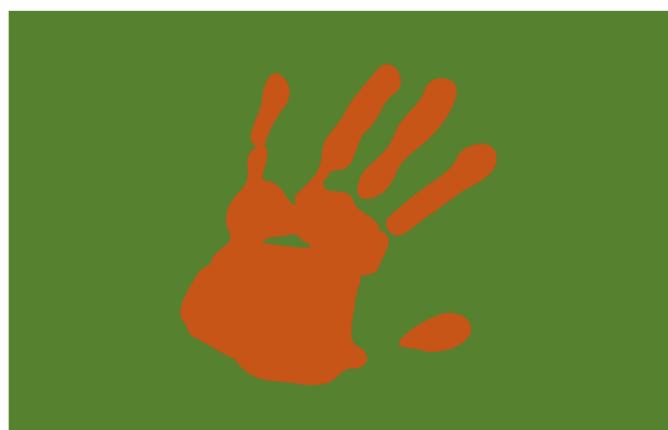
Termokrominen pinta vaihtaa väriä lämpötilan muutoksen seurauksena. Esimerkiksi kun pintaa painetaan hetken aikaa lämpimällä kämmenellä, jälki jää näkyviin erivärisenä. (Grafiikka: Ilkka Rajakallio ja Johanna Suominen)
