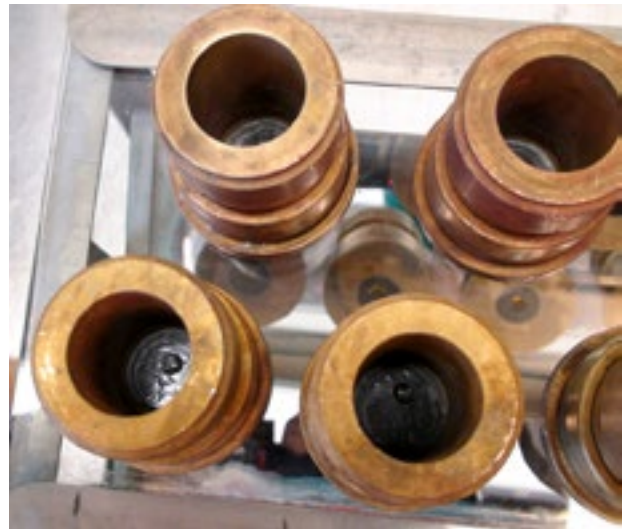
Kuva 5. Staattinen pidätystesti suojamateriaalille. (Kuva: Maaret Kinnunen)
