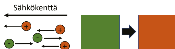
Elektroforeettisen pinnan väri vaihtuu väripigmenttien liikkuaessa sähkökentän vaikutuksesta. (Grafiikka: Ilkka Rajakallio)
