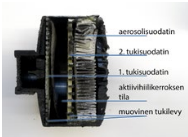
Kuva 2. Halkileikkauskuva suojanaamarin suodattimesta, aktiivihiili poistettuna. (Kuva: Timo-Jaakko Toivanen ja Johanna Suominen)
