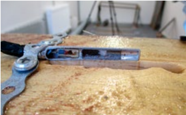
Kuva 7. VA-sähkönälli vesileikkattuna. (Kuva: PVTUTKL)
