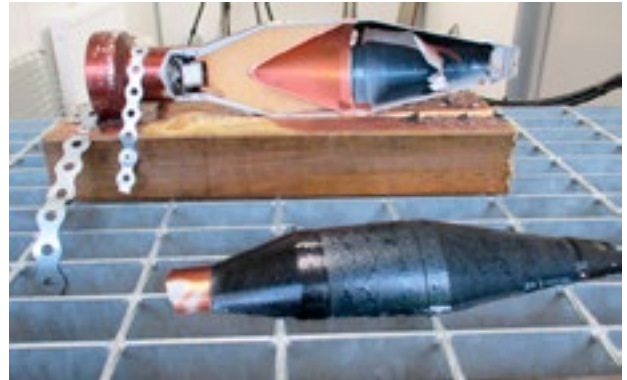
Kuva 8. Ontelokranaatti vesileikkattuna. (Kuva: PVTUTKL)
