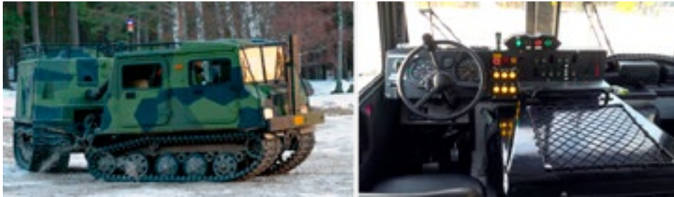
Kuva 2. Kaukokäytettävä miehittämätön telakuorma-auto testitilanteessa ja ohjaamo. (Kuva: Christian Andersson)
