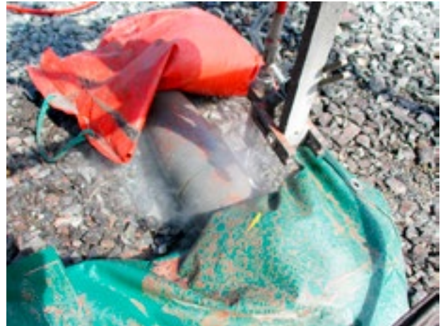
Kuva 6. 155 mm:n tykistökranaatin kuori vesileikkavana. (Kuva: PVTUTKL)
