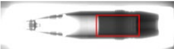
Kuva 5. Läpivalaisukuva 40 mm:n IF-ammuksesta. Epäilyttävä kohta merkitty punaisella neliöllä. (Kuva: PVTUTKL)
