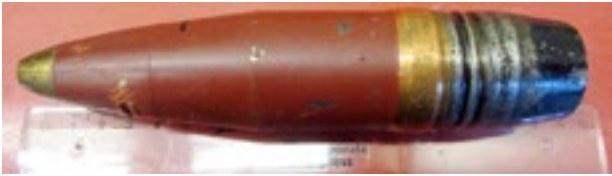
Kuva 4. Tutkittavaksi toimitettu 40 mm:n ilmatorjunta-ammus. (Kuva: PVTUTKL)
