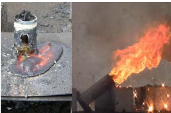
Kuva 2. ja 3. Puolen kilon polttopanoksen testauksen palojäänteet (vas.) ja modulaarisuuden testausta (oik.). (Kuvat: Marja-Leena Karisaari)
