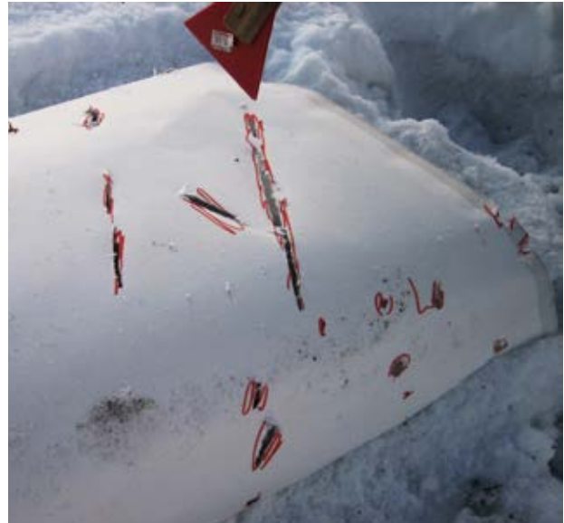
Kuva 3. Koeammunnoissa maalialkiona ollut kartonkilieriö, joka kuvaa maahan heittäytynyttä taistelijaa. Sirpaleosumat on merkitty punaisella tussilla ja laskettu. Eri suuntiin kulkevat viillot osoittavat, että lieriöön on osunut sirpaleita ainakin kahdesta eri kranaatista. (Kuva: Kari Stenius)
