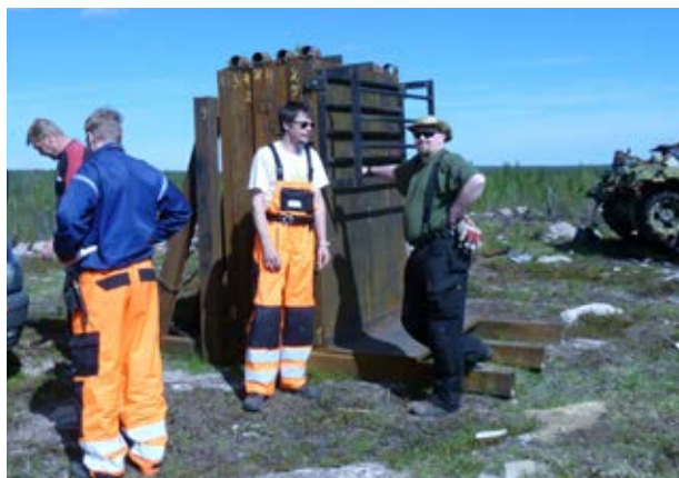
Panssarintorjuntaohjuksella ammutaan raskaaseen maaliin. 80 cm:n paksuinen teräslevypakka on koottu Rovajärvellä testiammuntaa varten kesäkuussa 2012. ERA-elementit kiinnitetään etupuolen teräsputkikehikkoon. Kuvassa Jukka Nenonen, Jarkko Mursu, Matti Kajala ja Janne Sandberg. (Kuva: Petri Wallgrén)
