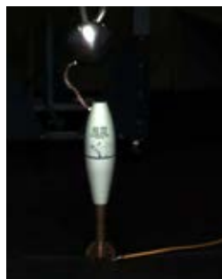
300 kV:n staattisen sähköön purkaus (ESD) inerttiin 120 mm:n krh-kranaattiin. (Kuva: Pauli Hokkanen)
