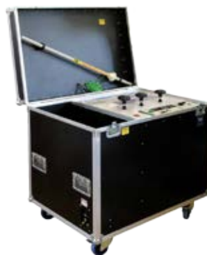
Henkilöperäisen staattisen sähköön testilaitteisto: vasemmalla 25 kV:n ESD-generaattori, oikealla ESD-elektrodi ja testattava ampumatarvike. (Kuvat: Petri Pekkala)
