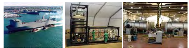
Kuva 2. MV Cape Ray -alus (kuva: Reuters) ja sille asennettava hydrolyysijärjestelmän reaktori (keskellä). 7 Kuvassa oikealla 8 näkyy jäte- ja reaktioainesäiliöitä aluksen kannen alla. Reaktori on säiliöiden takana olevassa valaistussa teltassa.
