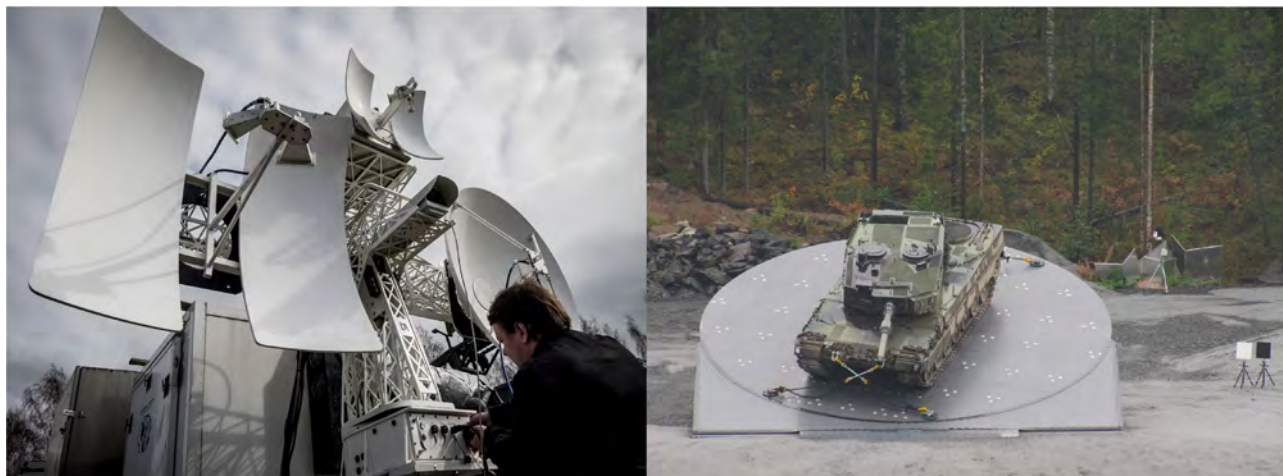
Kuva 1. Vasemmalla TUTRAn mittauskuntoon saattamista merivoimien mittauksissa keväällä 2018 ja oikealla Leopard 2A4 häiveteknisissä mittauksissa PVTUTKL:n kääntöpöydällä syksyllä 2009. (Kuvat: Onni Järvi ja Tiia Mattila)
