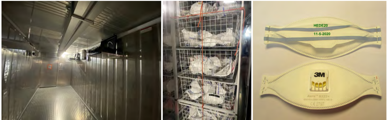
Kuva 3. Vasemmassa kuvassa tyhjä VHP-kammio. Cleamix Oy:n vetyperoksidigeneraattorit asetettiin hyllylle. Konttiin asennettiin lämmitys ja sekoituspuhaltimia. Keskikuvassa näkyy hengityksensuojaimia rullakoissa VHP-kammiossa. (Kuvat: Markku Mesilaakso). Oikeanpuoleisessa kuvassa on puhdistettu suojain ja siinä uusi merkintä HEDE20. (Kuva: Hanna Haukipää)
