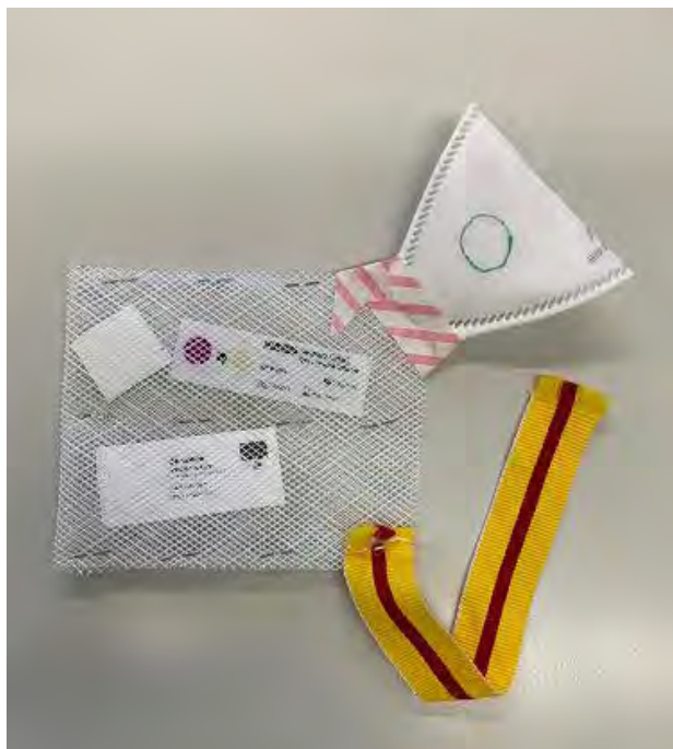
Kuva 1. Vetyperoksidihöyrytyksen tasaisen pitoisuuden ja leviämisen sekä dekontaminaatiotehokkuuden mittaamiseen käytettyjä indikaattoriliuskoja. (Kuva: Tuula Lehto)
