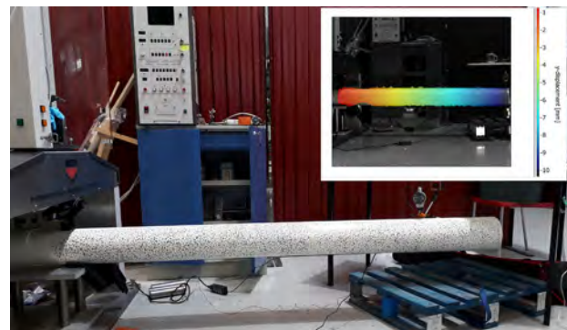
Kuva 6. Usean metrin pituisen onton komposiittiputken taipuman määrittäminen DIC-kuvauksella. (Kuva: Olli Orell)
