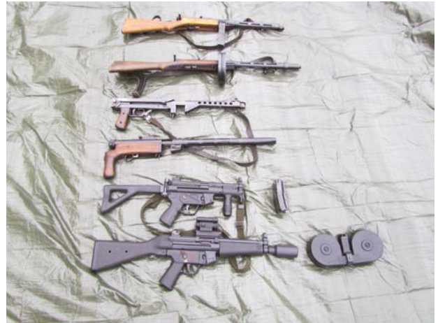
Kuva 8. Kuvassa ylhäällä jo aiemmin esitellyt suomalaiset konepistoolit, joiden alapuolella on H&K:n MP5K -konepistooli taittuvaperäisenä. Alinna on H&K:n MP5A5 -konepistooli kiinteällä perällä ja Aimpoint COMP5 punapistetähtäimellä varustettuna. Konepistoolin etupuolella on äänenvaimennin ja 100 patruunan rumpulipas.
