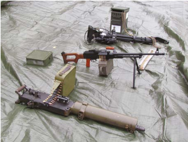
Kuva 6. Konekiväärien kehityskaari: etualalla on MAXIM-konekivääri, sen yläpuolella PKM-konekivääri ja kuvan ylälaidassa on Dillon M134 kuusipiippuinen konekivääri. Huomaa vyölaukkujen/ patruunakannujen patruunamäärien eroavaisuudet; tämä vaikuttaa suoraan tulituen kestoon.
