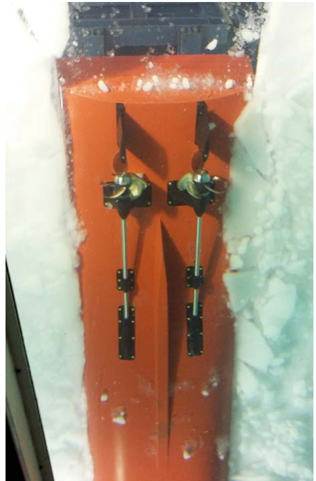
Kuva 1. Runkomuodon testausta mallilla jäämallikoeltaassa. Kuva on otettu aluksen alapuolelta. (Kuva: Jarmo Harras)
