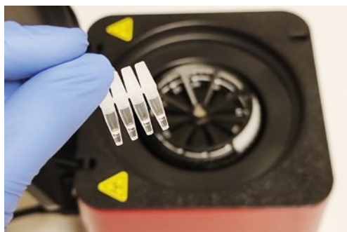
Näyteputken lisääminen kenttäkäyttöiseen ja pienikokoiseen PCR-laitteeseen.
