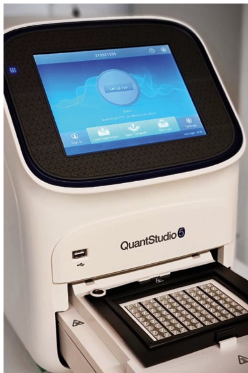
Standardi, laboratorioon sijoitettava PCR-laite, jolla pystytään analysoimaan 96 näytettä yhdellä ajokerralla.
