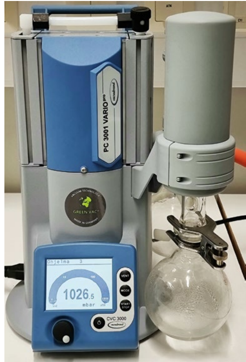
Vakuumiunuikuivausjärjestelmään kuuluva vakuumpumppu, jolla luodaan kuivauk- sessa tarvittava alipaine vakuumiuniin.
