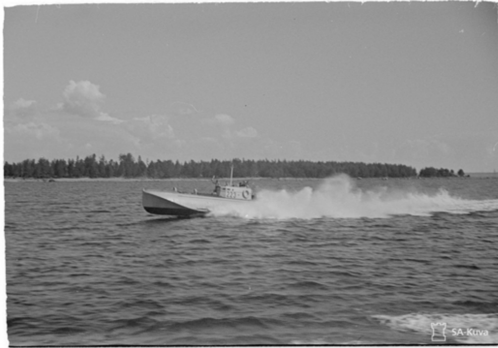
Moottoritorpedovene Viima ajaa Viipurinlahdella kesällä 1943. Viima oli Koivistolla sotasaaliiksi saatu Neuvostoliiton laivaston G5-tyypin moottoritorpedovene TKA-64. Kuva: SA-kuva
