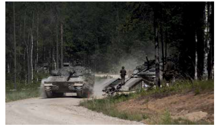
Virolainen rynnäköpanssarivaunu ylittämässä suomalaisen taistelupioneerijoukkueen rakentamaa Leguan-siltaa hyökkäyksessä.
