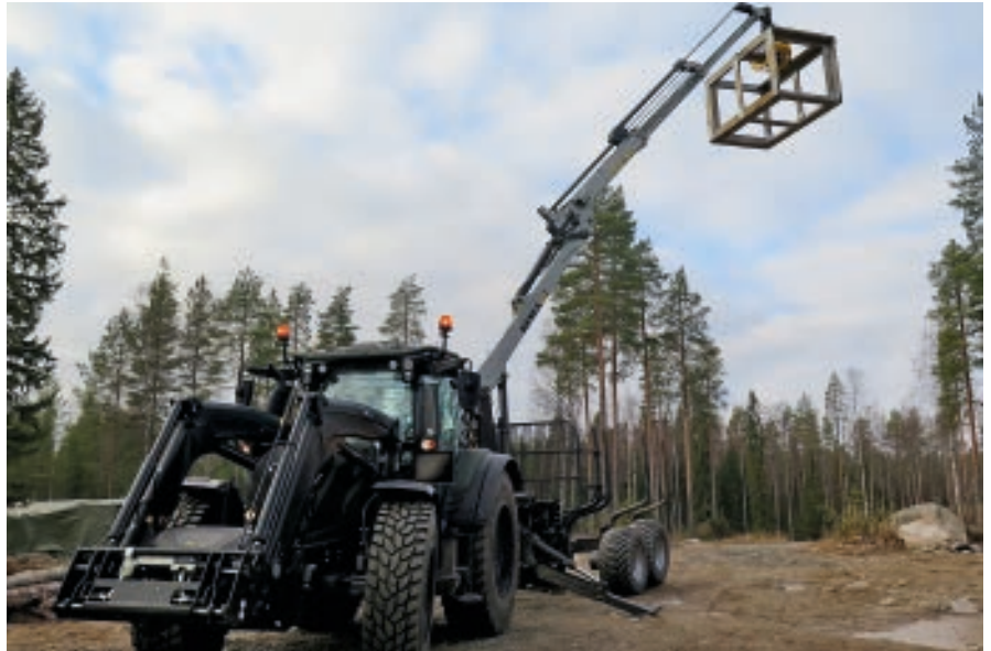
Liikennetraktorin ja metsäperävaunun kuormainten kenttäkokeet käynnissä linnoitustöiden tukena kuva: Pohjan pioneeripataljoona.
