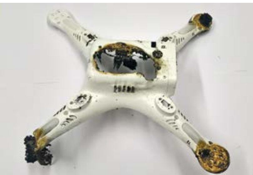
Kuva 2. Droonin runko laserin staattisen polttokokeen jälkeen. (Kuva: Sini Kivi)
