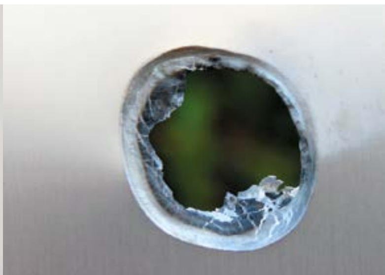
Kuva 3. Laserilla alumiinilevyyn sulatettu reikä. (Kuva: Tomi Parviainen)
