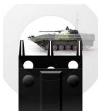
Då du skuter mot en vagn som rör sig ska du sikta med den mellersta stolpen på den främre tredjedelen av vagnen.
