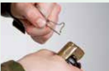
Vrid dragringen motsols tills böjningen på det övre benet hoppar bort från sin plats under sprintens nedre ben.
