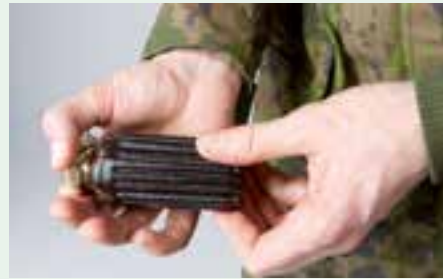
Skeden är i den kastande handen, med den andra handen skruvar man fast stommen i tändröret
