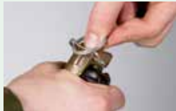
Lösgör med andra handen säkringssprintens dragring från transportsäkringens genom att trycka nedåt med tummen samtidigt som man med pek- och långfingeret lyfter uppåt så att dragringen frigörs.
