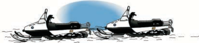
Moottorikelkan vetäminen Huom! Vedettäessä käytettävä joustavaa köyttä
