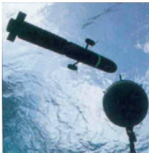
Kauko-ohjattava robotti vie räjähdyspanoksen miinaan.
