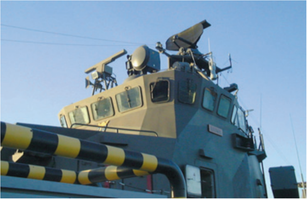
Rauma-luokan ohjusveneen tutka-antennit.
