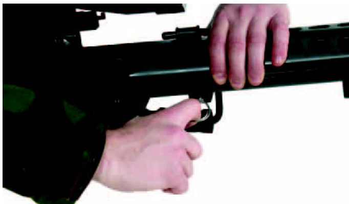
Kuva 144. Keskimmäisen lukitussokan irrottaminen
