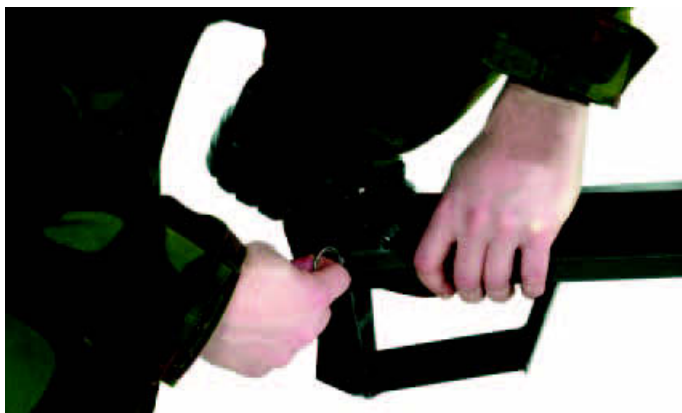
Kuva 143. Takimmaisen lukitussokan irrottaminen
