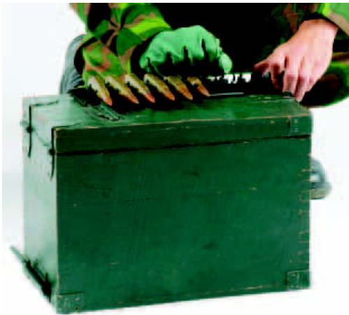
Kuva 96. Vyön täyttäminen vyöntäyttötasolla
