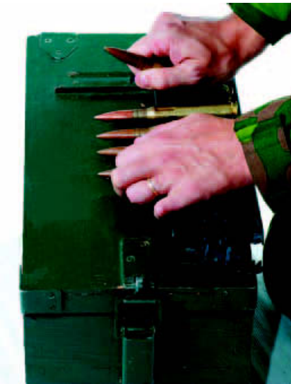
Kuva 101. Vyön tyhjentäminen vyöntäytötasolla
