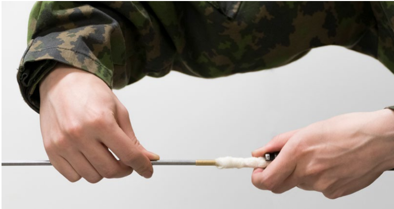
KUVA 81: Rynnäkkökiväärin piipun puhdistaminen
