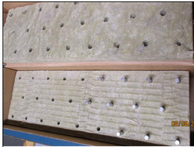
Kuva 9. Näyte 22RS141: tulilankanalli 11 kpl Forcitin 1.4S pakkauksessa (kivivillieriste). Lähde: PVTUTKL:n raportti
