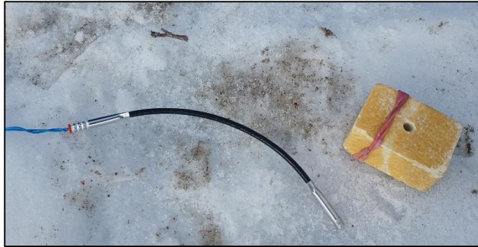
Kuva 3. Tulenkuvauskentän yksittäinen panos (TNT-puriste, P200R7BTNT) sekä sähkösytyke, johon kiinnitetty aikatulilankaliitos. Panoksessa reikä, johon nalli kiinnitetään. Lähde: Turvallisuustutkintaryhmä.
