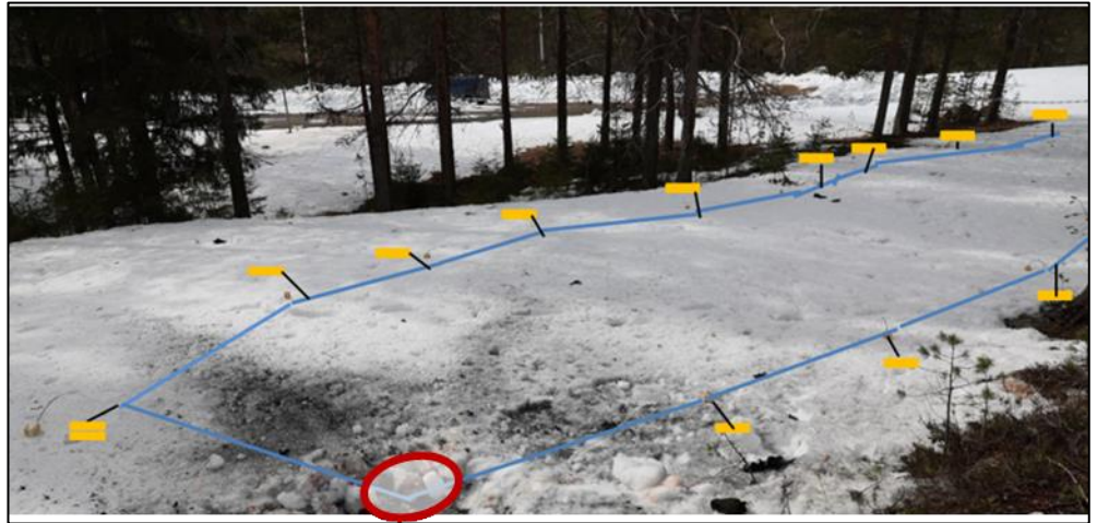
tu tulenosoituskentän rakenne. Keltaiset suorakulmiot kuvaavat TNT-panoksia. Räjähdyspaikka etualalla merkittynä punaisella ympyrällä. Lähde: Lapin poliisilaitoksen ja turvallisuustutkintaryhmä.
