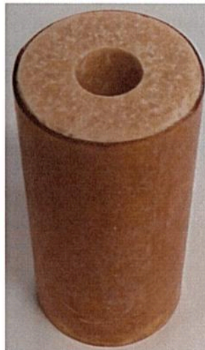
Kuva 9. Onnettomuudessa olleen toisen heittopanoksen räjähdysainepuriste 60 g (porapanos).
