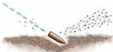
Splitterverkan vid ytkrevad, hårt underlag (artilleri)
