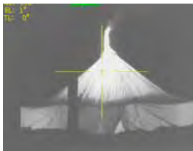
Omaskerat tält avbildat med värmekamera efter 15 min. uppvärmning
