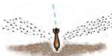
Splitterverkan, hårt underlag (GRK)
