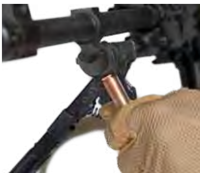
Reglering av gasregulatorn med hjälp av en hylsa
