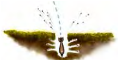
Splitterverkan, mjukt underlag (GRK)
