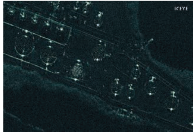
Kuva 3. Iceye-tutkasatelliitin kuva BP:n öljynjalostamosta Brisbanesta. SAR-kuvan erotuskyky on parempi kuin yksi metri. Öljysäiliöiden metalliset kattorakenteet ja öljyputket tuottavat voimakkaan tutkaheijastuksen. (Kuva: Iceye)
