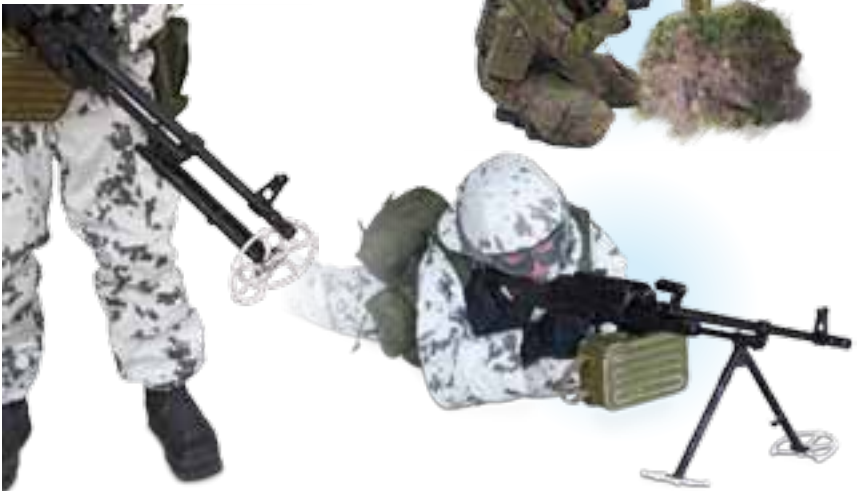
Lumisena aikana konekiväärin etutuen jaloissa käytetään suksisompia kantavuuden lisäämiseksi
